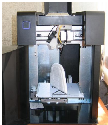
Рис. 2. Процесс печати модели объемного следа обуви на 3D принтере
